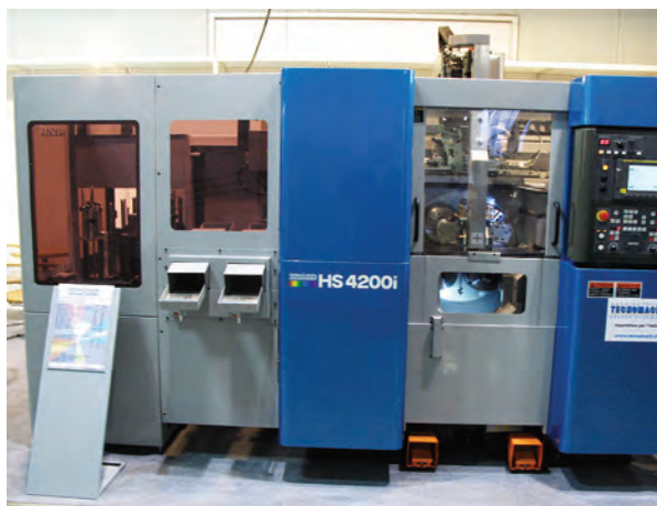
Obr. 6: Čtyřvřetenový stroj Kitako HS 4200i - pohled na celý stroj a detail vřeten
