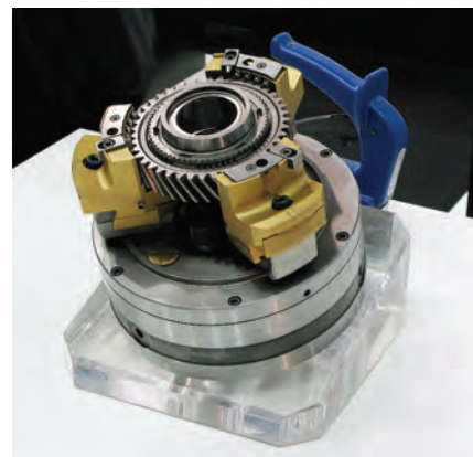
Obr. 42: Příklad speciálního upnutí obrobku (Tobler)
