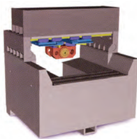
Obr. 30: Nosná struktura stroje Kümmer k250 hydrospeed a detail pohybové skupiny vřetená s konceptem LSK
