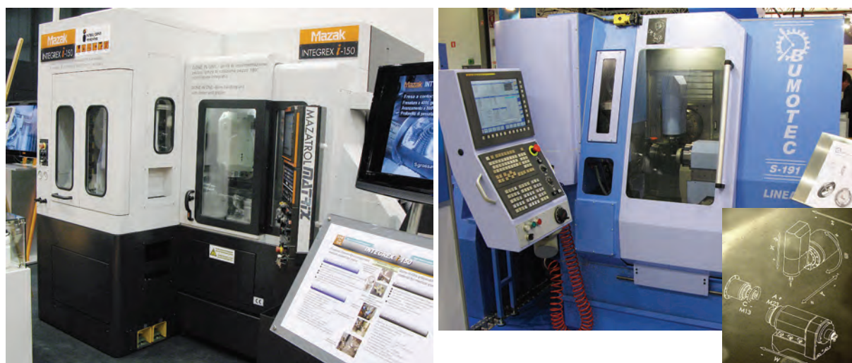
Obr. 14: Mazak Integrex i-150 se zásobníkem na 72 nástrojů Obr. 15: Malé multifunkční centrum Bumotec S-191 linear
