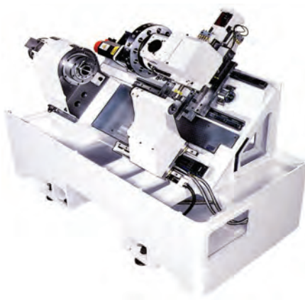
Obr. 28: Nosná struktura a detail vřeteníku stroje Hardinge GS
