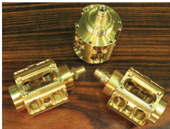
Obr. 10: Příklady tvarově složitých obrobků vyrobených na soustružnickém centru Mori Seiki NZ
