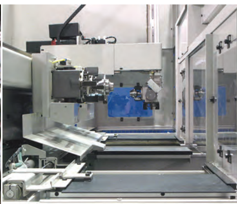
Obr. 4: Pohled z boku na manipulátor nad pracovními jednotkami
