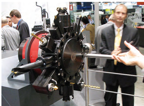
Obr. 9: Revolverová hlava Sauter vybavená jednomotorovou technologií
