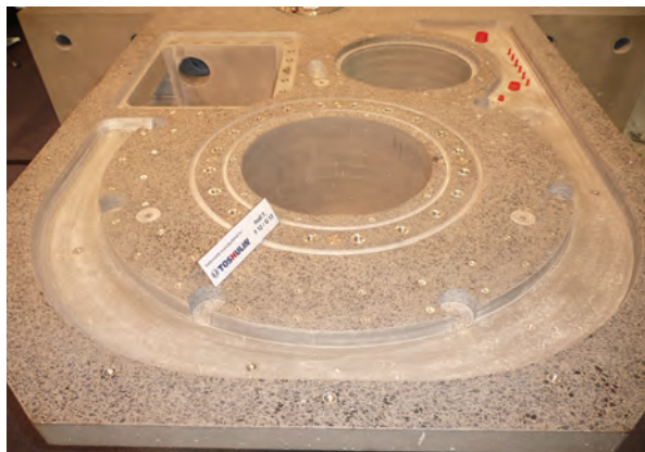
Obr. 5: Cementové betonové lože stroje POWERTURN
