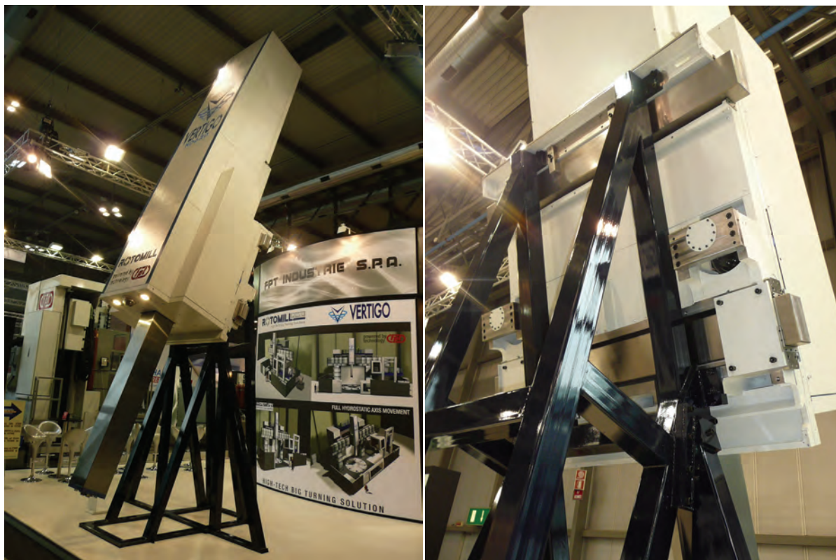
Obr. 1: Stánek firmy FPT prezentující stroj Rotomill a pohled na masivní plochy hydrostatického vedení stroje Rotomill
