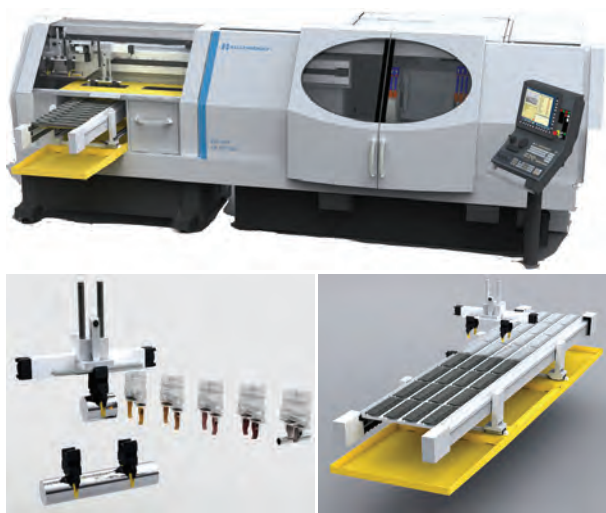
Obr. 3: Nahoře Kel-Vita s manipulací Kel-Portal; dole úchopná hlavice a zásobník obrobků
