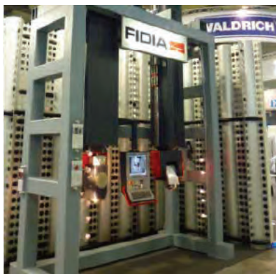
Obr. 30: Nabídka celých kompletních vřeteníků i se souvise řízenými hlavami a vřeteny od společnosti FIDIA
