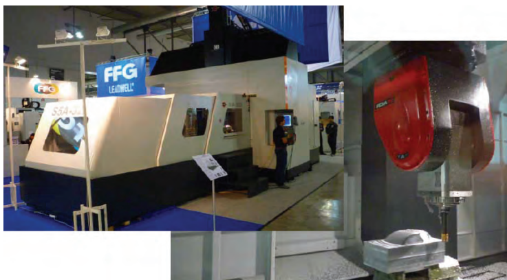
Obr. 31: Stroje S5A-3220 společnosti FFG-SANCO využívá kompletní dodávky osy Z, C, A a vřetene od firmy FIDIA a nikterak se tím netají, jak znázorňuje pohled do pracovního prostoru stroje
