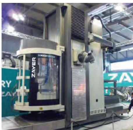
Obr. 32: Horizontální frézovací a vyrtávací stroj střední velikosti firmy Zayer s velmi kvalitním designem, estetickým pracovištěm obsluhy a plně krytovanou zadní částí stroje.
