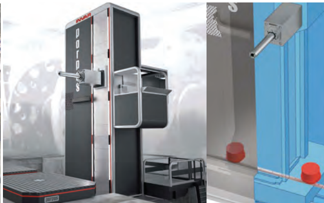
Obr. 35: Největší stroje PARPAS užívají náhon osy X typu master-slave s ozubeným hřebenem a pastorky. Zajímavý je však přímý náhon pastorku prstencovým motorem.
