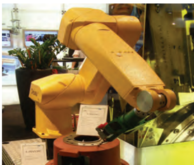
Obr. 2: Aplikace vrtací jednotky L MAX 16C firmy SUHNER s robotem STÄUBLI
