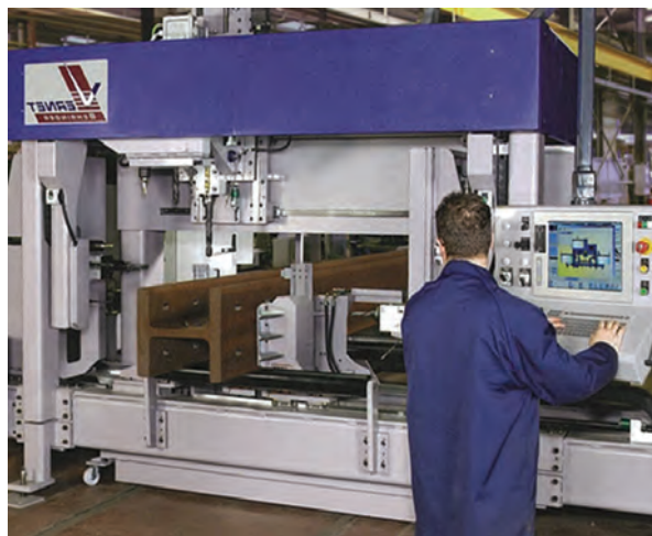
Obr. 13: NC vrtačka firmy VERNET-BEHRINGER HD 900
