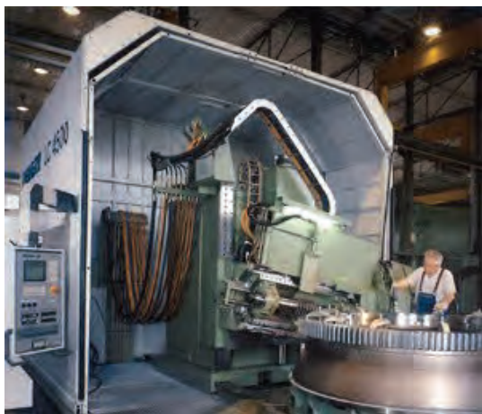
Obr. 6: Liebherr odvalovací frézka LC 4500 pro kola průměru až 4,5m
