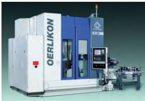
Obr. 5: Oerlikon CNC frézka C29 pro kuželová kola. Vpravo: největší měřicí stroj na ozubení, Klingelberg P 200
