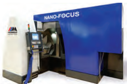
Obr. 38: Špičkové pětiosé centrum firmy Hembrug označené NANO-FOCUS 425. Užitá hydrostatika na všech osách, přímé pohony, granitové nosné dílce. (Pro zajímavost: hmotnost stroje 15t, max. hmotnost obrobku 75kg)
