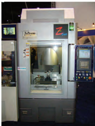
Obr. 36: .Stroj Z \mu 3500 firmy NTC určený pro mikroobrábění. Všechna vedení jsou bezkontaktní hydrostatická, pohony realizovány lineárními motory, speciální krytování s minimalizací pasivních odporů
