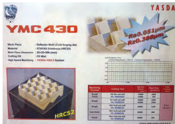
Obr. 10: Příklad obrobenej mikroskopické struktury na stroji YASDA YCM 430
