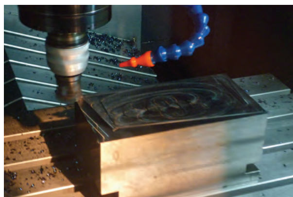
Obr. 23: Příklad zkušebního kusu s možností porovnání obrobeneých povrchů při různě nastaveném systému HECC firmy HWACHEON.
