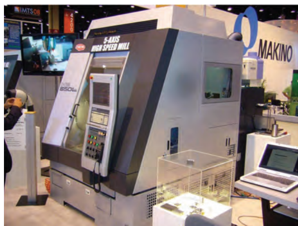
Obr. 34: Špičkové pětiosé frézovací centrum HS650Linear pro obrábění v submikronových přesnostech od firmy SODICK
