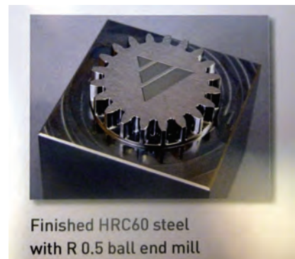
Obr. 8: Příklad obrobku z nástrojové oceli o tvrdosti HRC 60 dokončovaného kulovou frézou o průměru 1mm na stroji YASDA YCM 430
