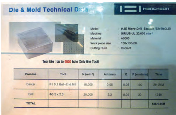
Obr. 27: Příklad mikrovtřání mřížky s otvory o průměru 0,2mm na stroji HWACHEON SIRIUS UL.
