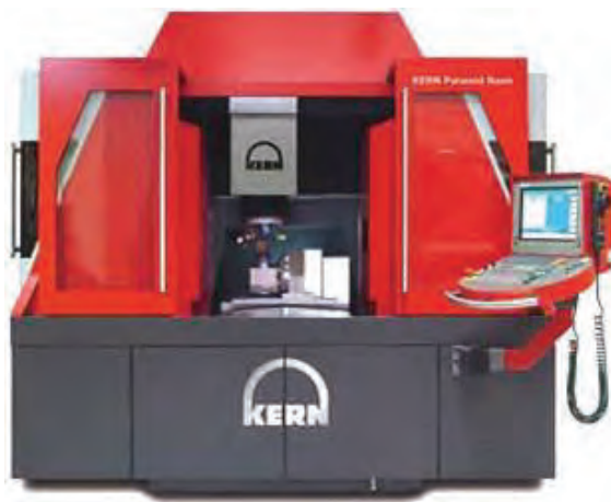
Obr. 37: Švýcarský stroj Pyramid Nano od formy KERN. Stroj užívá nejen hydrostatická vedení, ale také pohon pomocí hydrostatických trapézových šroubů uložených na hydrostatických ložiskách.
