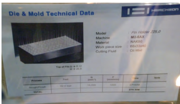
Obr. 29: legenda příkladu obrábění jehlic průměru 0,12mm a výšce 25mm z plného materiálu na stroji HWACHEON M2-5AX.
