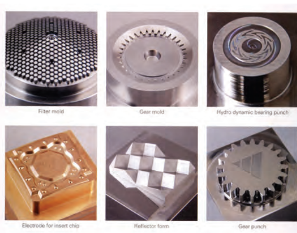
Obr. 4: Příklad obrobků realizovaných na stroji YASDA YCM 430
