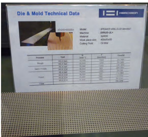
Obr. 26: Příklad obrobeneých plochy nástroj vstříkovací formy na stroji HWACHEON SIRIUS-UL+.
