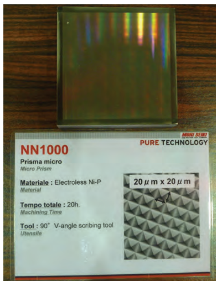
Obr. 17: Příklad obrábění jehlanové mřížky s podstavou jehlanů 20x20um. (Mori Seiki NN1000)
