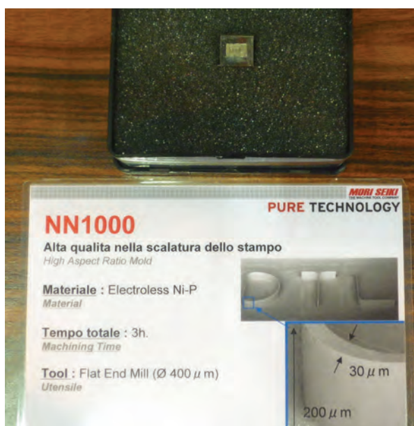
Obr. 15: Příklad obrábění textu DTL, kde tloušťka písma činí pouhých 30um a výška 200um. (Mori Seiki NN1000)
