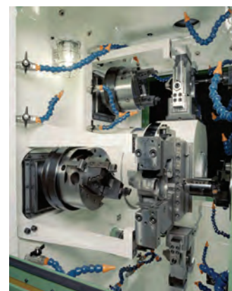
Obr. 14: Pracovní prostor stroje s horizontální osou bubnu firmy Porta
