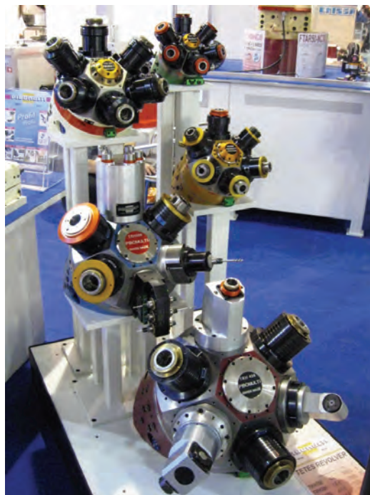
Obr. 24: Revolverové hlavy typ TRH firmy Pibomulti
