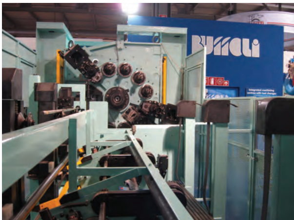
Obr. 10: Podavač tyčí bubnového stroje firmy Buffoli Transfer
