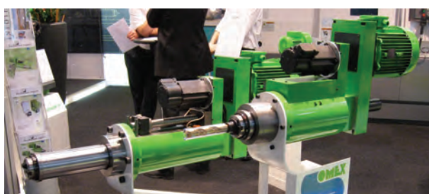
Obr. 22: Modulární skladba jednotek MAG
