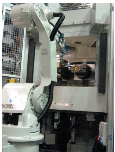
Obr. 6: Stroj TRV-nakládání obrobků pomocí robotu
