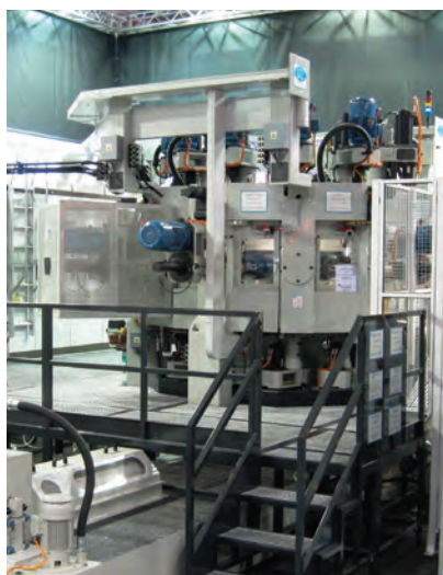
Obr. 5: Stroj TRV s vertikálním otočným bubnem
