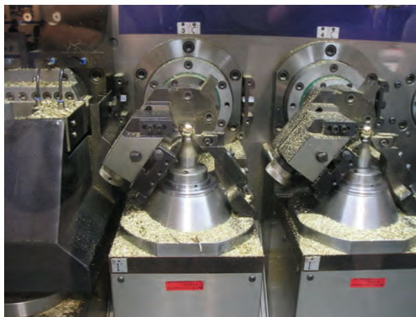
Obr. 15: Obrábění koulí na lince FLEXIBALL
