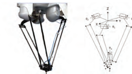
Obr. 2: Schéma paralelní kinematické struktury
