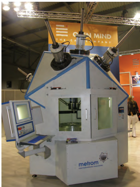
Obr. 3: Obráběcí stroj Metrom P1000 a detail jeho paralelní kinematické struktury
