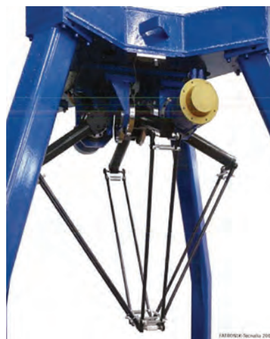
Obr. 11: Vysokodynamický manipulátor Fatronik vyvinutý v rámci evropského projektu Next
