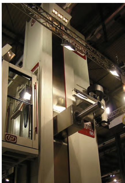
Obr. 4: Vystavovaný stroj SPIRIT 460 a koaxiální uspořádání pohonu
