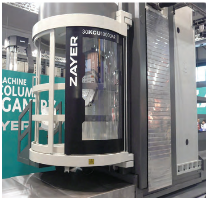
Obr. 19: Kabina obsluhy stroje Zayer 30KCU10000AR
