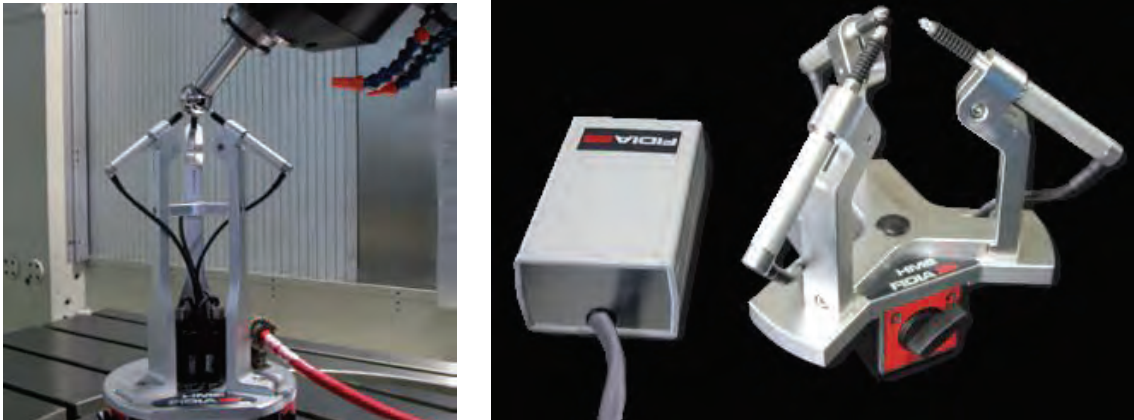
Obr. 19: Kontrola přesnosti pomocí nízkozdvihových čidel (FIDIA)
