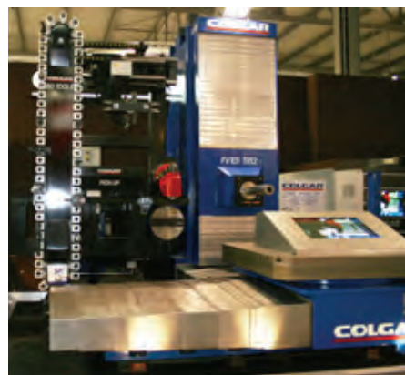
Obr. 7: Systém výměny nástrojů a vřetenových hlav na stroji Colgar FV101
