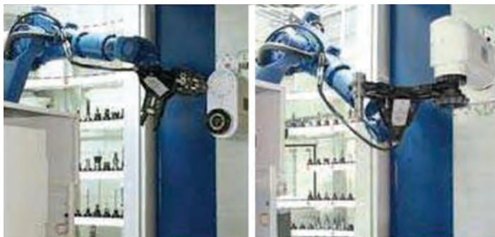
Obr. 5: Výměna nástrojů u stroje firmy Pama Obr. 6: Systém AVN Tool Arena firmy Demmeler při výměně nástroje v horizontální a vertikální poloze
