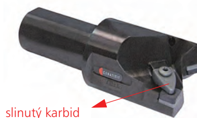
Obr. 5: Nástroj s upínacím prvkem ze slinutého karbidu.
