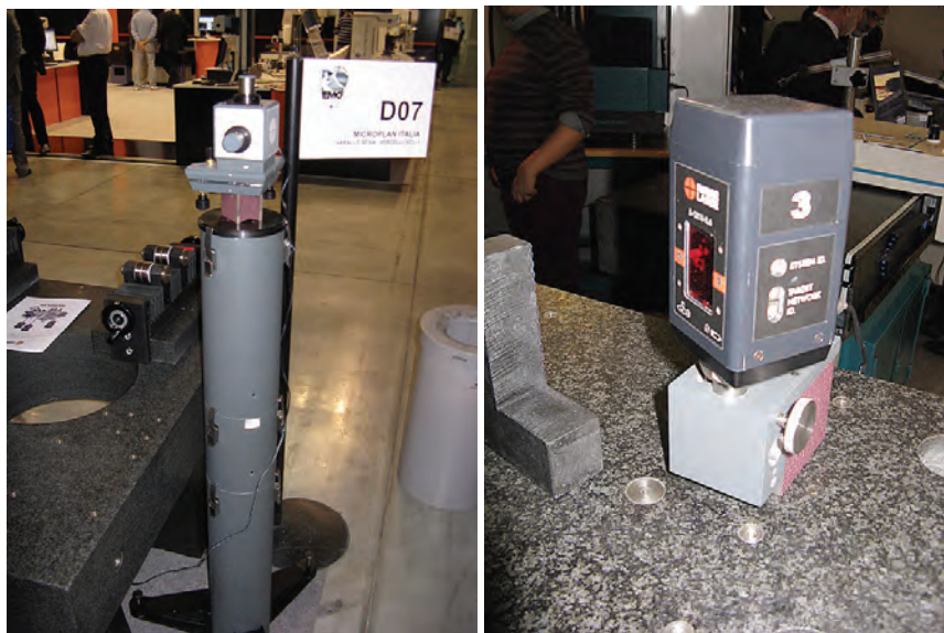
Obr. 7: Hamar Laser. Laserová hlava na stojánku (vlevo) a Target (vpravo).
